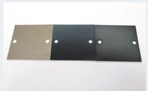
左から無電解Niめっき、黒色無電解Niめっき、黒色クロムめっき
